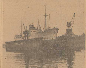
På tidigare sidor Finnboða var sin nya stora flytdocka med en förlängning av 2500 ton d. w. Luffhessens stycke på dockan har en lyktkraft på respektive 2 och 10 ton.
