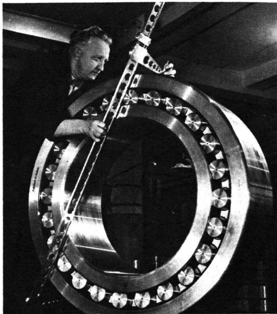
Vi hävda oss genom att producera kvalitetsvaror. Bilden visar kontrollmätning av ett stort sfäriskt SKF rullager.
